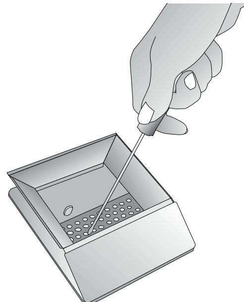
Abb. 11: Reinigung des Brenntopfs
