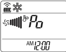
Die Schnellkühlfunktion dient zum schnellen Abkühlen der Raumtemperatur im Sommer. In dieser Betriebsart wird das Klimagerät 30 Minuten lang im Kühlungsbetrieb mit sehr hoher Lüftergeschwindigkeit und einer Temperatureinstellung von 18°C betrieben, um den Raum schnell abzukühlen.
