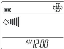
In diesem Betriebsmodus wird die Luft ohne Kühlung oder Erwärmung umgewälzt. Diese Betriebsart wird durch Drücken der BETRIEBSWAHLTASTE aktiviert. Die Luft wird daraufhin umgewälzt, wobei Sie die Strömungsgeschwindigkeit der Luft über die WAHLTASTE FÜR DIE LÜFTERGESCHWINDIGKEIT DES INNENGERÄTES anpassen können.
