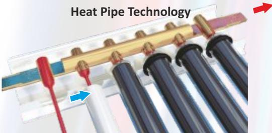
Das Heat Pipe besteht aus zwei konzentrisch liegende Glasrohren und Vakuum dazwischen. Die Oberfläche des Innenrohres ist mit selektiver Beschichtung für maximale Absorption der Sonnenstrahlen und hoher Wirkungsgrad beschichtet. Im Zentrum des Heat Pipes befindet sich ein leeres Kupferröhrchen, in dem Prozesse der Verdampfung einer unschädlichen Flüssigkeit stattfinden. Diese Flüssigkeit leitet die Wärme nach oben zum Kollektorknoten, wo sie denn an der wärmeleitenden Flüssigkeit abgegeben wird.
