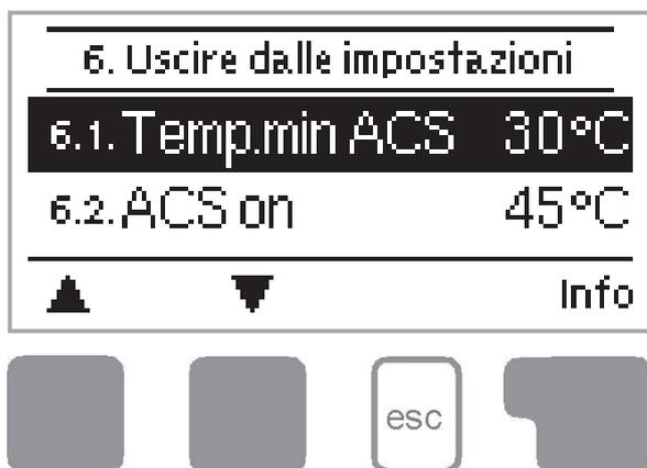
Le impostazioni necessarie per il controllo del riscaldamento dell'acqua calda sanitaria vengono fatte nel menu "6. Impostazioni ACS".
