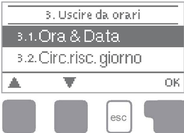
Il menu “3. orari” è utilizzato per impostare l’orario, la data e orari di funzionamento circuito riscaldamento.
