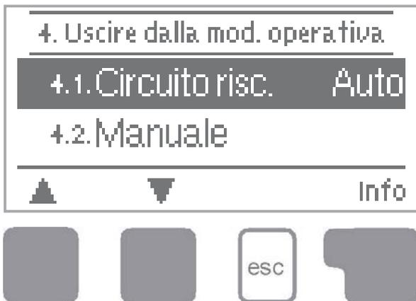
Il menu “4. modi operativi” è utilizzato per specificare il modo operativo per il circuito di riscaldamento.
