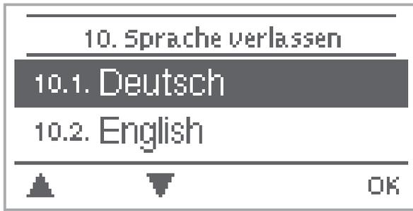
Über das Menü "10. Sprache" kann die Sprache der Menüführung gewählt werden. Bei der ersten Inbetriebnahme erfolgt die Abfrage automatisch.
