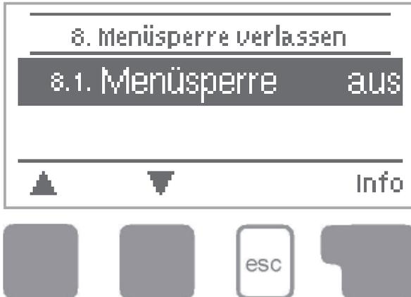
Durch das Menü "8. Menüsperre" kann der Regler dagegen gesichert werden, dass die eingestellten Werte unbeabsichtigt verstellt werden.
