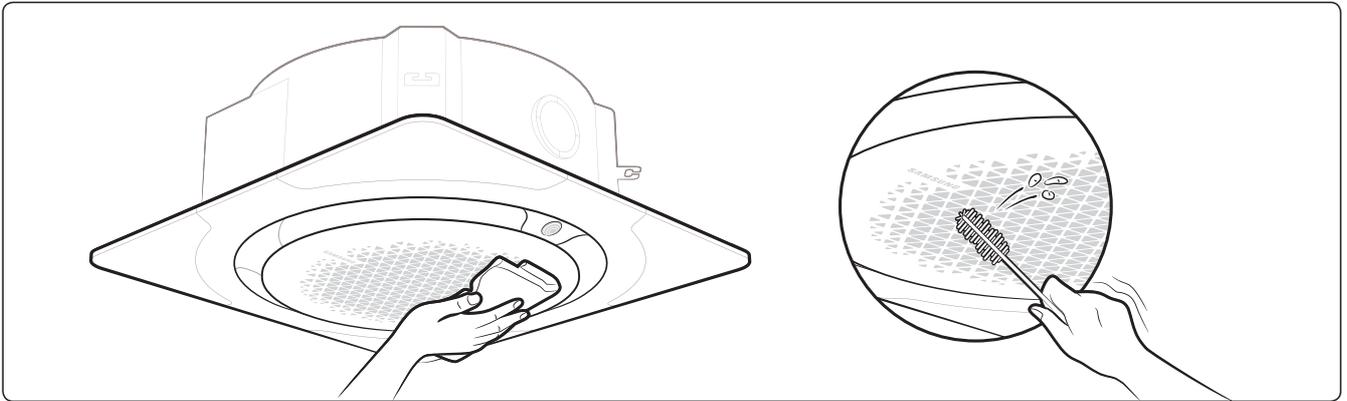
Wischen Sie die Oberfläche des Geräts bei Bedarf mit einem leicht feuchten oder trockenen Tuch ab. Entfernen Sie Schmutz aus schlecht zugänglichen Bereichen mit einer weichen Bürste.
