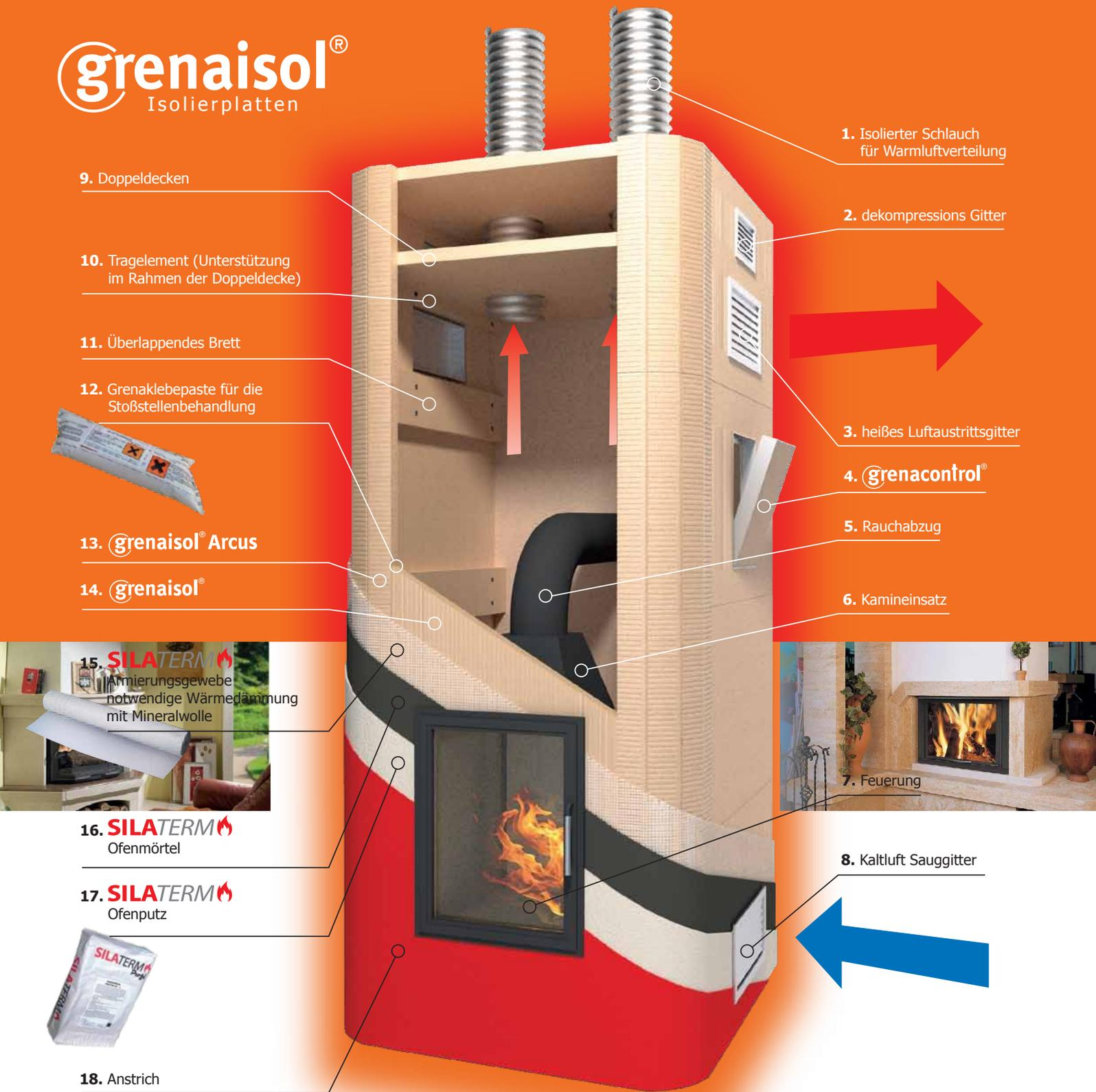
1. Isolierter Schlauch für Warmluftverteilung
