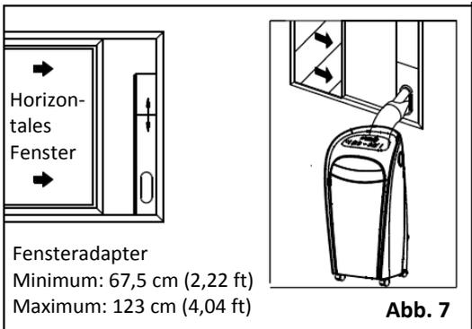
**Anmerkung:** Wenn die Fensteröffnung kleiner ist wie die angegebene Minimallänge für den Fensteradapter, schneiden Sie den Teil mit der Öffnung auf die richtige Länge zu. Schneiden Sie niemals das Loch im Fensteradapter heraus.
