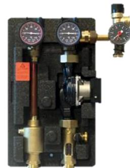
Der Volumenstrom, der in der Anlage umgewälzt wird, ist abhängig von der Betriebsweise, der Kollektorfläche sowie der Leistung des sekundären Wärmetauschers. Die Auslegung der Umwälzpumpe ist abhängig vom Volumenstrom und den Druckverlusten, die im Wärmetauscher, im Kollektor, in der Verrohrung und den Armaturen der Anlage entstehen.
