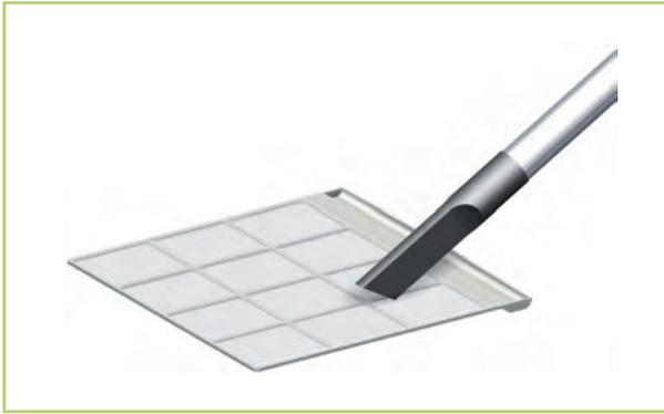
Abb. 16: Reinigung mit dem Staubsauger
