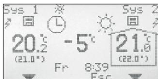
Pfeil nach unten drücken in jedem Heizkreis: Sie kommen direkt in das Basismenü für den gewählten Heizkreis. Einstellungen für Heizkreis 1 (Sys 1) und Heizkreis 2 (Sys 2) sind in der Bedienungsanleitung der EC Home erklärt und sind exakt dieselben, wie bei Betrieb mit nur einem Heizkreis. Drücken Sie Esc für 1 Sekunde, kommen Sie immer wieder auf das gemeinsame Grundmenü zurück.
