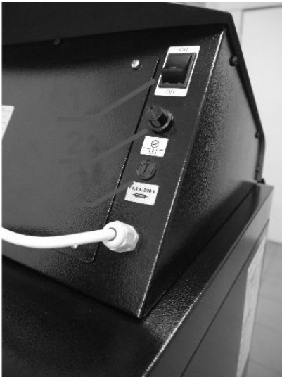
Bild 17. 1 – Hauptschalter, 2 – Havarie Thermostat, 3 – Sicherung (F6,3A)
