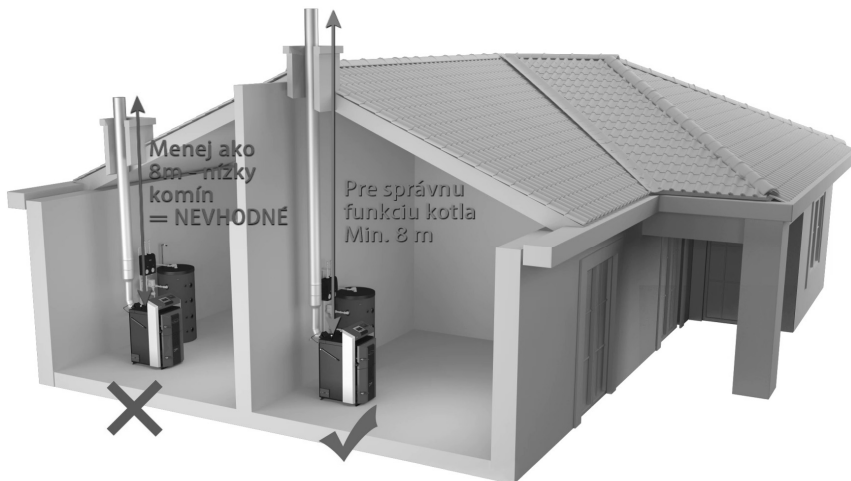
Bild 3. Richtige und falsche Kaminparameter des Kesselanschlusses SLX
