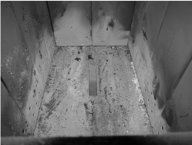
Bild 6. Richtig gereinigte Ladungskammer
