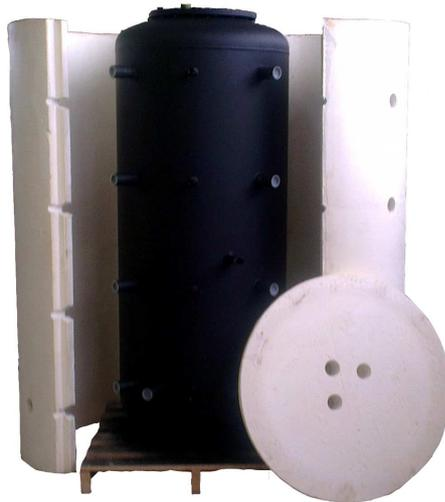
4. Den beigefügten Dichtstreifen beidseitig zwischen Nut/Feder-Verbindung der PU-Hartschalen einfügen und fixieren. Danach PU-Deckel aufsetzen.
