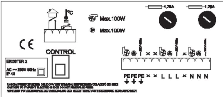
Abb.2 Blick von hinten auf die reglung: Anschlussschema.
