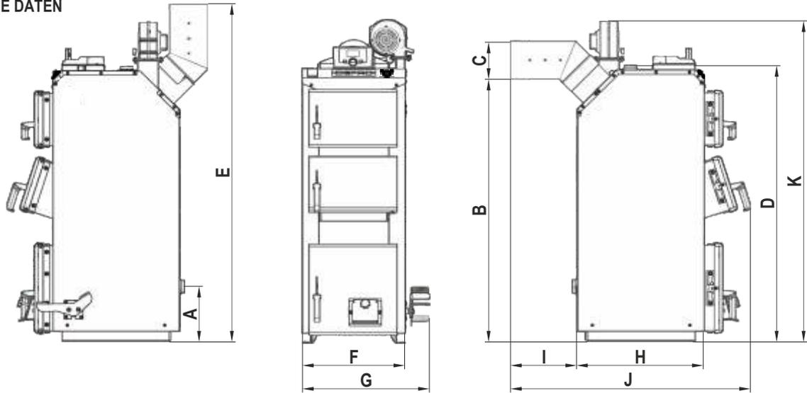
Abbildung 1. Grundmaße von Heizkesseln OPTIMA PLUS COMFORT.
