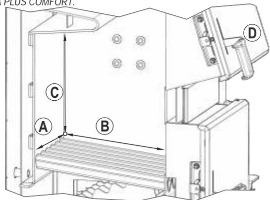
Abbildung 2. Abmessungen Ladekammer und die Einfüllöffnung OPTIMA PLUS COMFORT.
