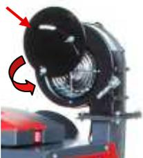
Vor dem Betrieb mit einem Feuerzugsregler muss der Drosseldeckel an dem Gebläse nach unten gestellt werden, so dass das Gebläse damit ganz bedeckt ist. Es ist auch sicherzustellen, dass die Kesselkreis-pumpe mit Strom versorgt werden kann, um die Wärme aus dem Heizkessel ins Heizsystem abzutransportieren, sonst kommt es zur Überhitzung des Heizkessels und eventuellen Schäden am Kesselkörper.
