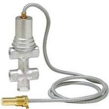
Bei der Montage muss man besonders darauf achten, dass der Fühler, der sich im unteren Bereich des Ventils befindet, im Heizungswasser getaucht ist.
