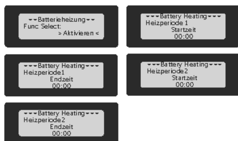
Abbildung 9-88 Batterieheizung aktivieren und Arbeitszeiten einstellen
