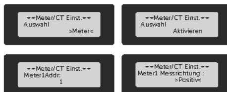
Abbildung 14-14 Meter für den Wechselrichter einstellen
