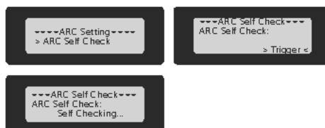
Abbildung 9-101 ARC Self Check auslösen
