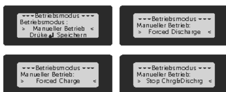
Abbildung 9-11 Elemente in der Schnittstelle Manueller Betrieb einstellen
