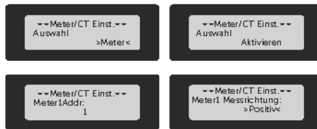
Abbildung 14-9 Meter für den Wechselrichter einstellen
