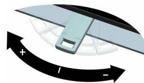
Fig. 4: Regolazione della levetta dell'aria
