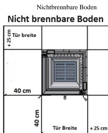
Abb.. 8. Mindestmaße der Schutzverkleidung
