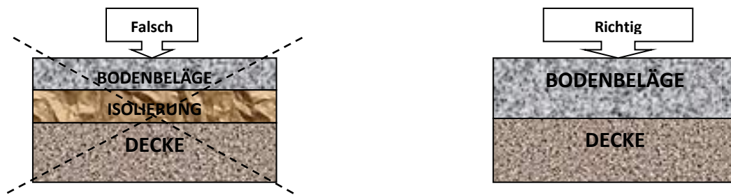
Abb. 9. Vorbereitung des Bodens
