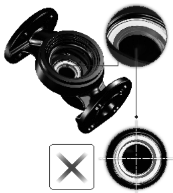
Falsch zentriertes Dichtungssystem
