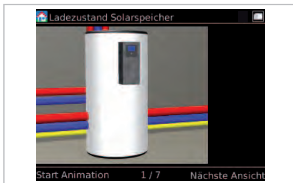
Abb. 19: Komponenten-Zoom Ladezustand Solarspeicher
