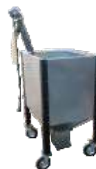
Schnecke nachfüllen (CPSP-BP 800 - System zum Befüllen von Pellets mit einer Förderschnecke aus einem Behälter - 800 Litern)
