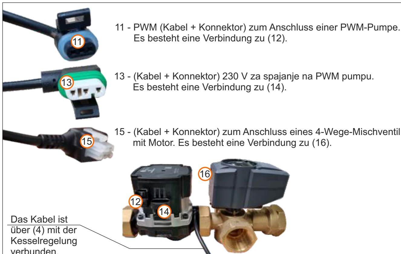
Bild 5. Konnektoren / Kabel mit Konnektoren, die während der Montage des Kessels angeschlossen werden müssen
