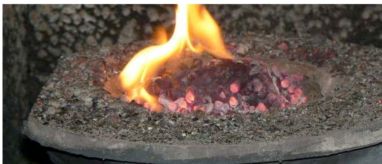
Abbildung 19. Lage der Pellets auf dem Retortenbrenner beim Kesselbetrieb. Ling 15–50kW.
