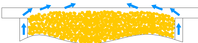
Abbildung 18. Lage der Pellets auf dem Retortenbrenner beim Kesselbetrieb.
