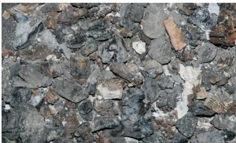
Abbildung 17. Kohlenverschlackung (Sinterung) – falsche Brennereinstellung im Verhältnis zur Brennstoffqualität.
