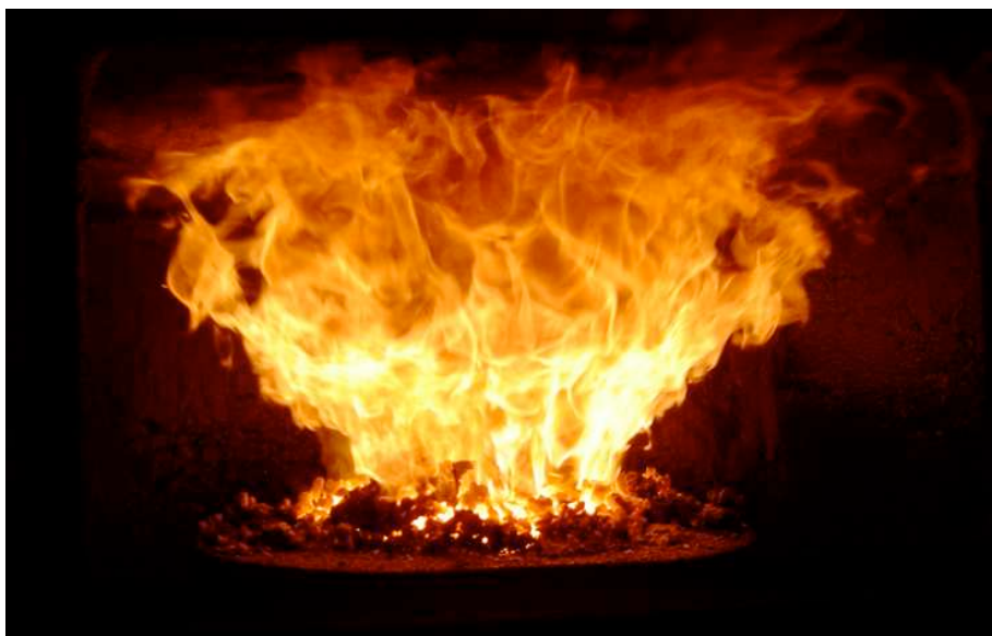
Abbildung 16. Retortenbrenner während der Beheizung mit Kohle, Ling 75kW. Betriebs- und Installationsanleitung LING DUO
